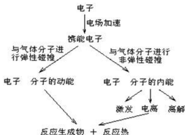
图 6.1-4 低温等离子装置工作原理示意图
